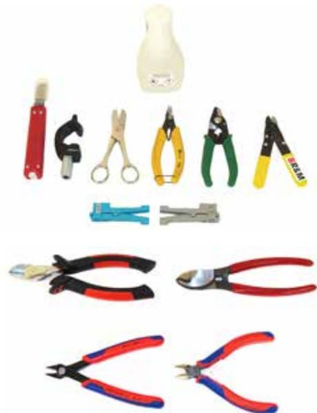
Outils pour la préparation et la terminaison des câbles à fibres optiques
